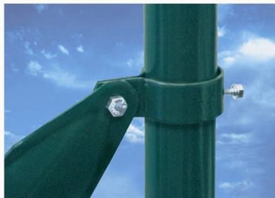
6.- **Colocar 3 abrazaderas con el tensor de alambre**, en los postes de arranque y esquina. Si la distancia entre ambos postes es considerable, hacer lo mismo en los postes de centro. Los tornillos de las abrazaderas se colocarán hacia el exterior del cercado.
