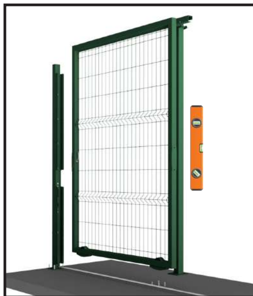
Introducimos el pilar guía con los rodillos sobre el perfil de la hoja. El siguiente paso es colocar la puerta sobre riel y poner a plomo.
